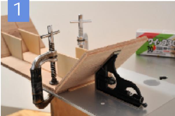
45°のマグネットシートを貼る傾斜面の角度は、コンビネーションスコヤの物差し部分を外した、本体を使いました。スコヤの45°面に両面テープを貼り、傾斜板には小さな穴を2つあけ、細い針金で互いを密着させてあります。この状態で、ベース板に接着しました。初めは片方のガイドだけで、箱をテスト製作しましたが、隙間が生じたため、もうひとつガイドを追加しました。スコヤ本体と板の間に使った両面テープの一部を二重にして角度を微調整しました。そのあと、切り離して2つのジグにしました。
