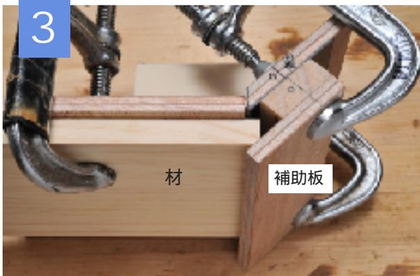
テストカットを繰り返すうちに、フェンスが不要だということに気づきました。左写真のように45°面を延長する補助板をクランプし、直角に切り出した材をそこにあてがえばいい訳です。これにより精度がぐんとアップしました。使用に際しては、材の端から実際に切り込みが入る位置までのオフセット距離が生じますが、その分を見越して材を切り出せば解決できます。ジグコン参加で、考案に集中したことが新しい発見を生んでくれました。
