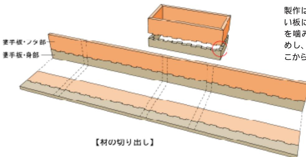
製作は、4枚の板を切り出す前の長い板にあられ加工します。その2枚を噛み合わせ、ガムテープで仮留めし、1枚の板として扱います。そこから4枚を切り出し、箱にします。あられ組み加工は2枚一緒に加工します。
