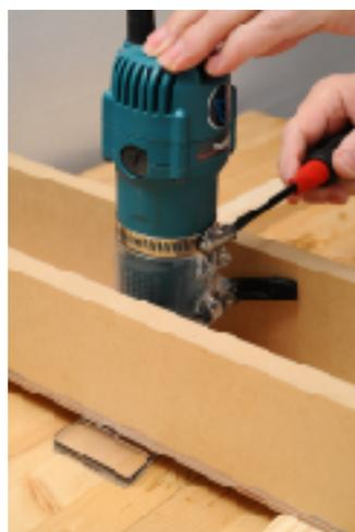
ホースクランプをトリマーハウジング（透明プラスチック部）の周囲に接するように固定すると切削深さストッパーとして使える。下に見えるのはアクリル板を重ね、希望の厚みにしたスペーサー。この厚みが材の厚みになる。トリマービット先端をこのスペーサーまで下げる。使用するトリマービットは刃径が大きいと効率的な作業につながる。
