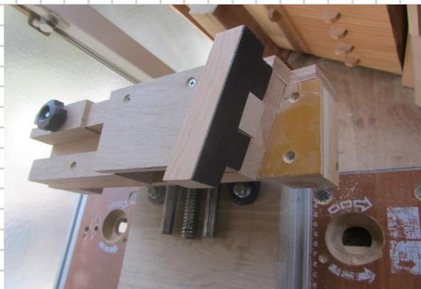
脚に接する3本の貫の長さを正しく、等しく挽くための治具。長さは貫が脚と接する高さ方向の寸法から計算で求めることができる。
